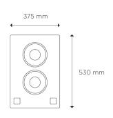
额定功率, IEC268 100W 额定功率, 峰值 400W 灵敏度, 2,83V/1m 88dB 最大声压值,持续 108dB 最大声压值,峰值 114dB 频率响应 30-240Hz 阻抗 8Ω 工作原理 无源辐射 尺寸(HxWxD) 530x375x190mm 重量 10.6kg
